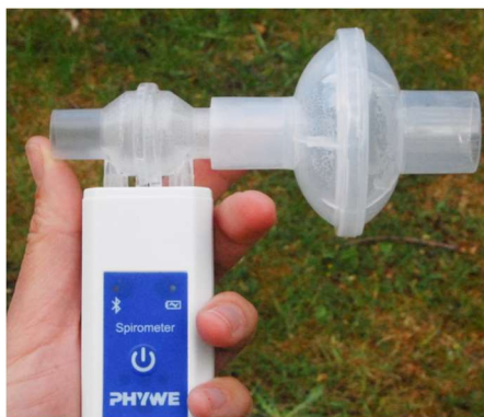
Rysunek 2. Spirometr z prawidłowo zamontowanym ustnikiem.
