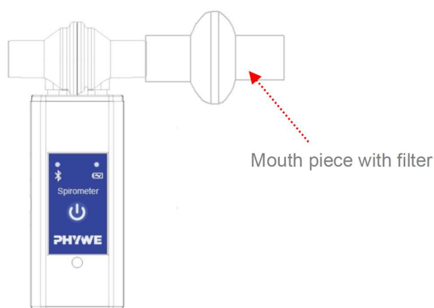
Rysunek 2. Prawidłowo zamontowany ustnik.
